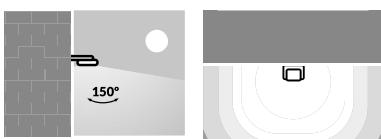
Óptica simétrica de 150° que extiende la luz hasta casi la paralela de la luminaria. Recomendada para altas interdistancias entre puntos de luz.
