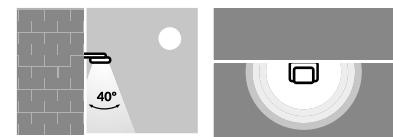
Óptica intensiva simétrica, para abarcar distancias medias y largas. Utilizada en campos de fútbol e iluminación arquitectónica.
