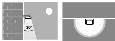
Óptica intensiva simétrica, para abarcar distancias medias y largas. Utilizada en campos de fútbol e iluminación arquitectónica.
