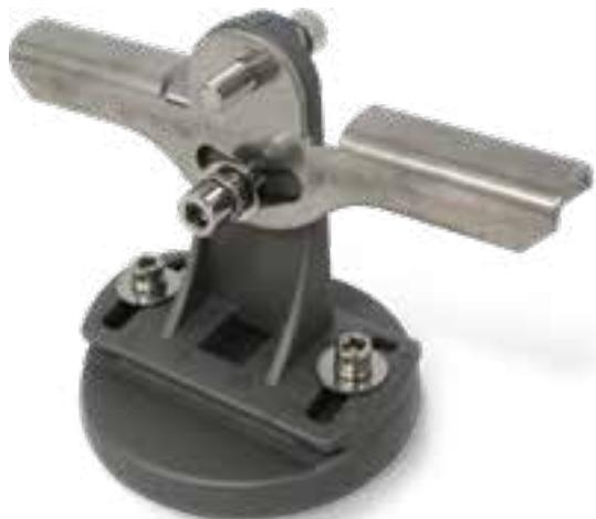
Accesorio adaptador con cuerpo fabricado en inyección de aluminio y soporte en acero inoxidable para los modelos GEF. Permite la instalación de la luminaria en un sistema de catenarias.
